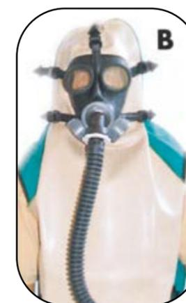
Equipe de travail équipé avec masque type "B". Doté d'un système anti brouillard et un régulateur de débit d'air avec filtre pour réservoir l'air du tube d'alimentation après avoir été filtré, permettent ainsi de travailler dans un maximum de confort en ambiance fermée. Equipé avec filtre anti-huile cristaux ronds et tube pour l'aération du masque.
